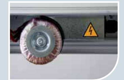
Gruppo trasformatore e filtro
